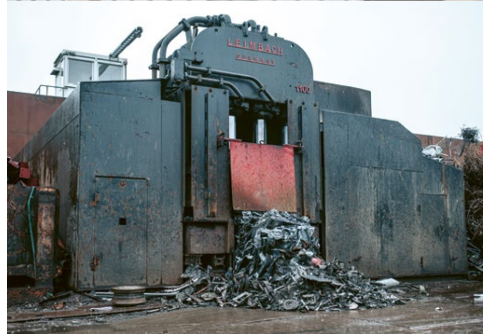
Nach der Zerkleinerung des Metalls durch das hydraulisch betriebene Scherenmesser verringert sich das Schrottvolumen erheblich und kann platzsparend verladen werden.
